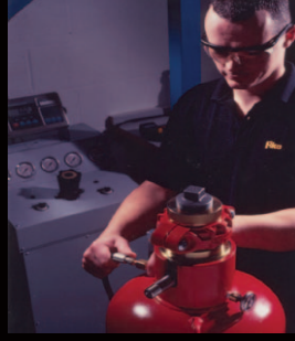
FE-227 Gazlı Yangın Söndürme Sistemi
